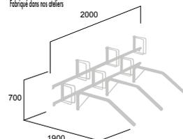
**JONCTION** Potelet de pose au sol et de montage linéaire en batterie sans abri
